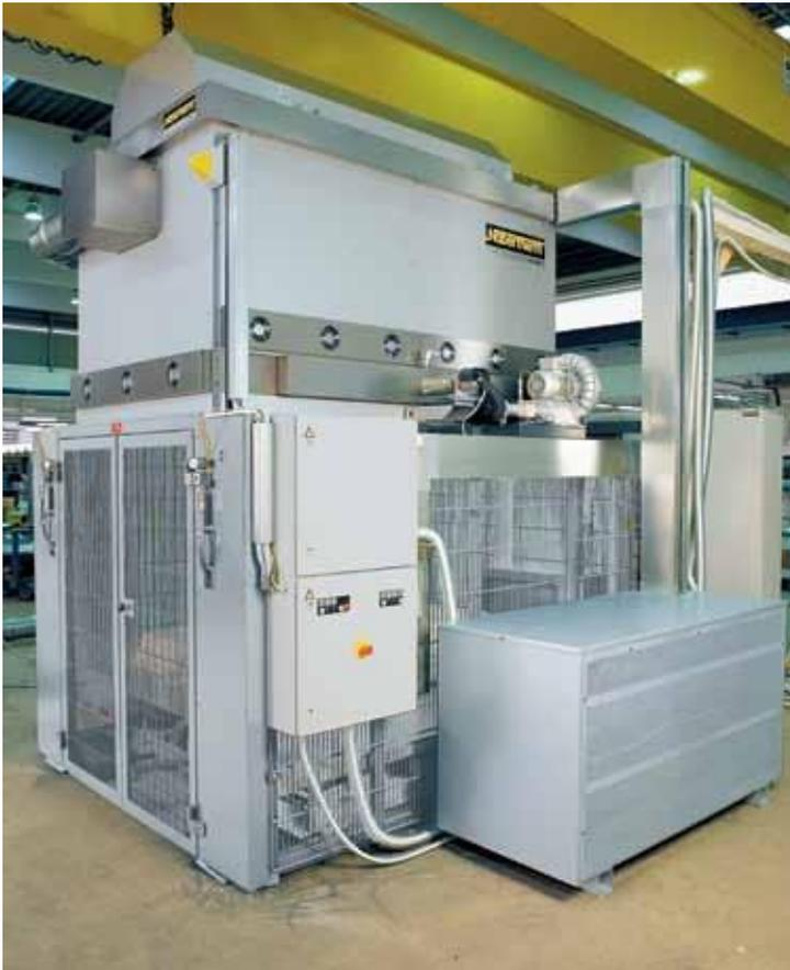
Комбинированная высокотемпературная установка HT 1440/17 LBS с устройством каталитического дожигания для выжигания и спекания в одном процессе
