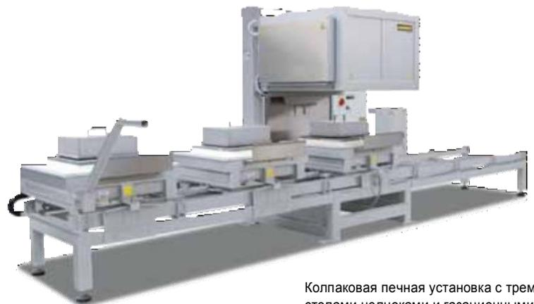
Колпаковая печная установка с тремя столами-челноками и газационными камерами для агломерации в среде негорючего защитного или реакционного газа
