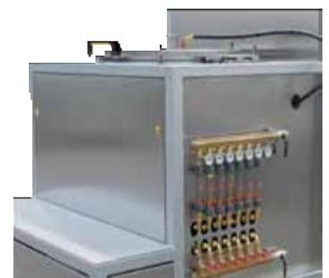
Система регулирования водяного охлаждения
