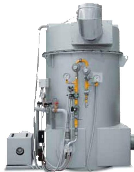
Установка для термического дожигания
