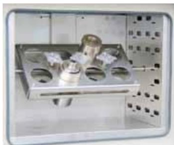
Электрическое поворачивающее устройство в качестве дополнительного оснащения
