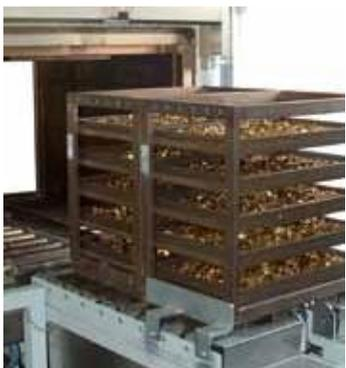
Проходная печь для термообработки клепок
