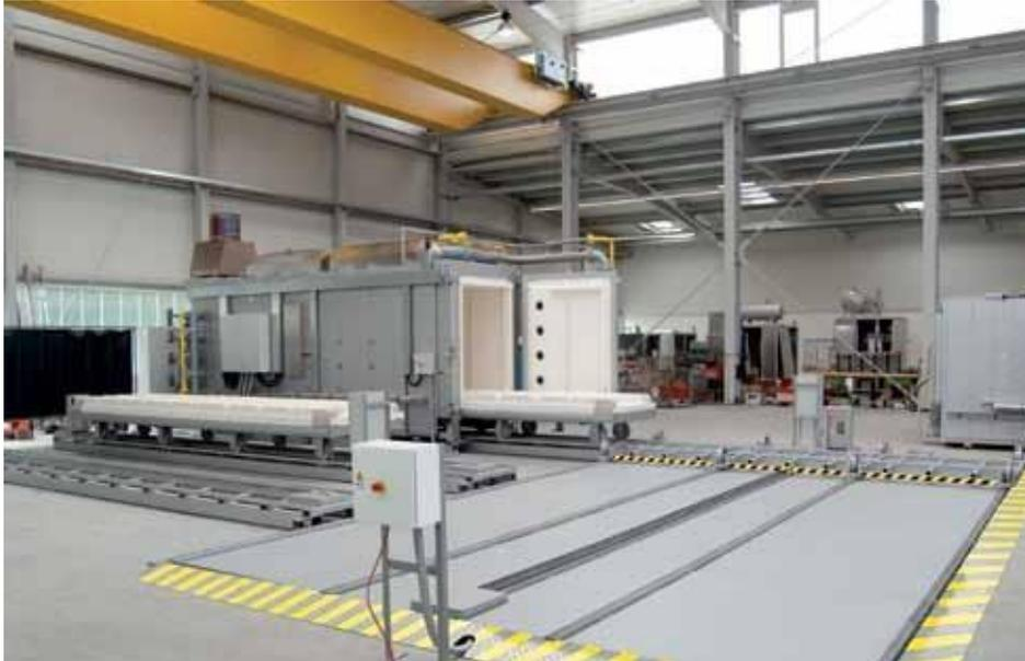
Комбинированная печная установка, состоящая из двух печей с выдвижным подом W 5000/H с установленной системой перемещения подов и двумя дополнительными подами, включая необходимые запасные направляющие
