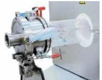
Кварцевое стекло и фланцы для работы с защитным газом в качестве дополнительного оснащения
