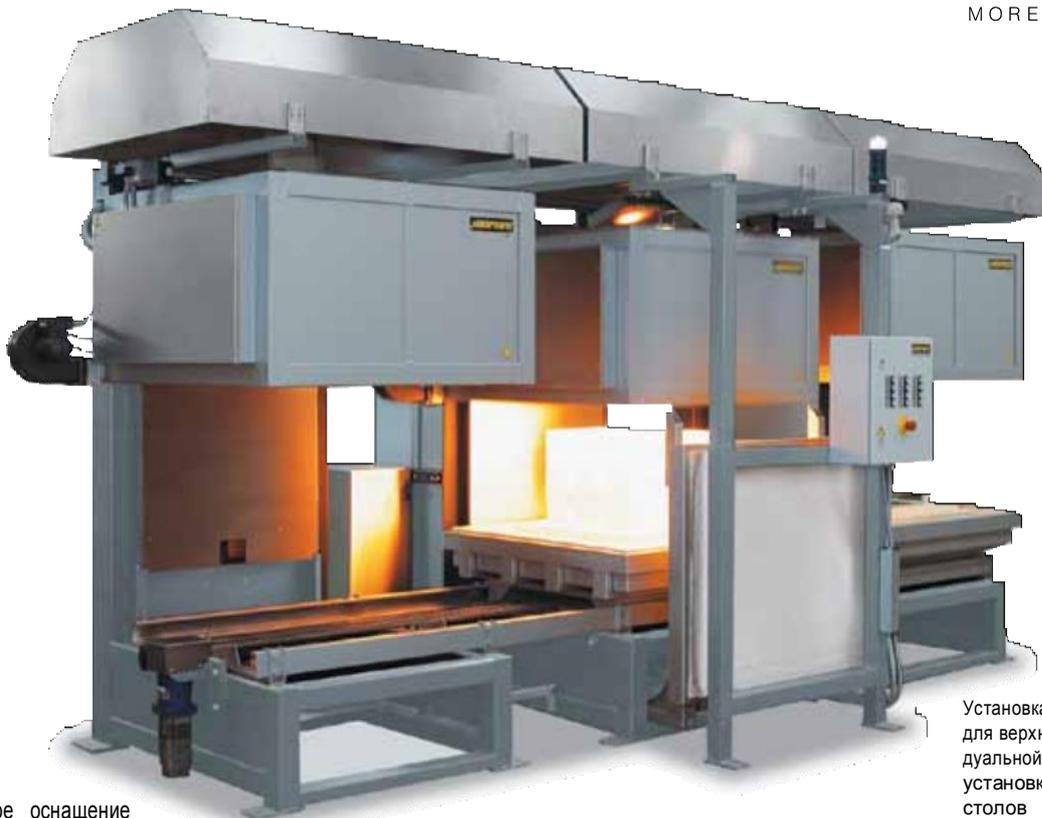
Установка с элеваторным механизмом для верхней крышки H 245/LTS в индивидуальной комплектации с охлаждающей установкой и установкой для смены столов
