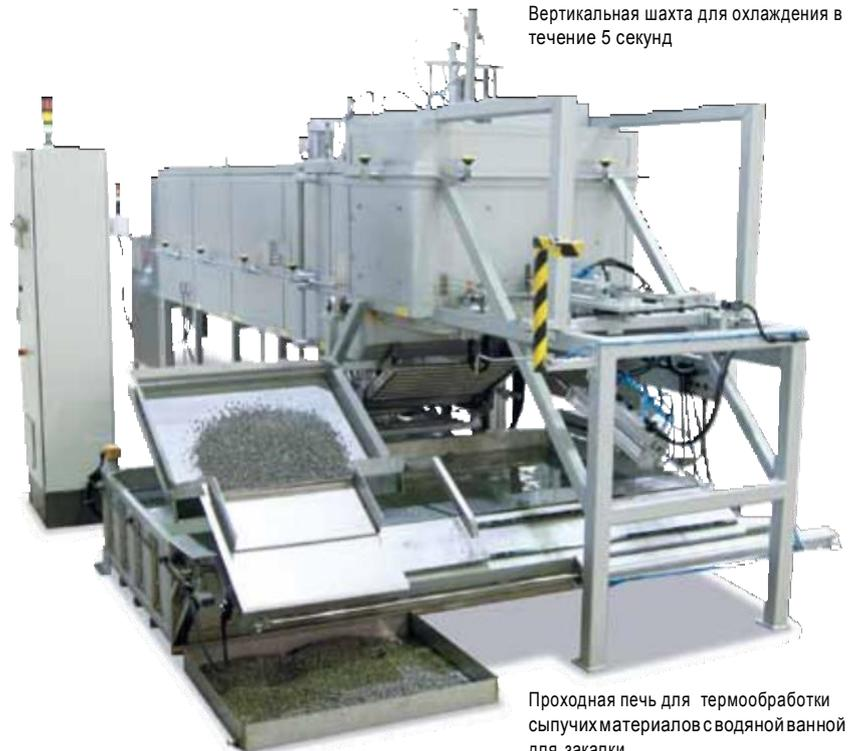
Проходная печь для термообработки сыпучих материалов с водяной ванной для закалки
