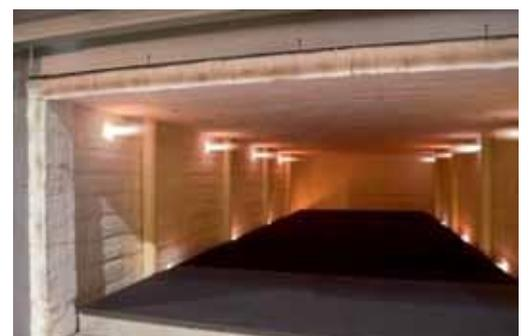
Внутреннее пространство печи с восемью горелками сверх-быстрого сжигания
