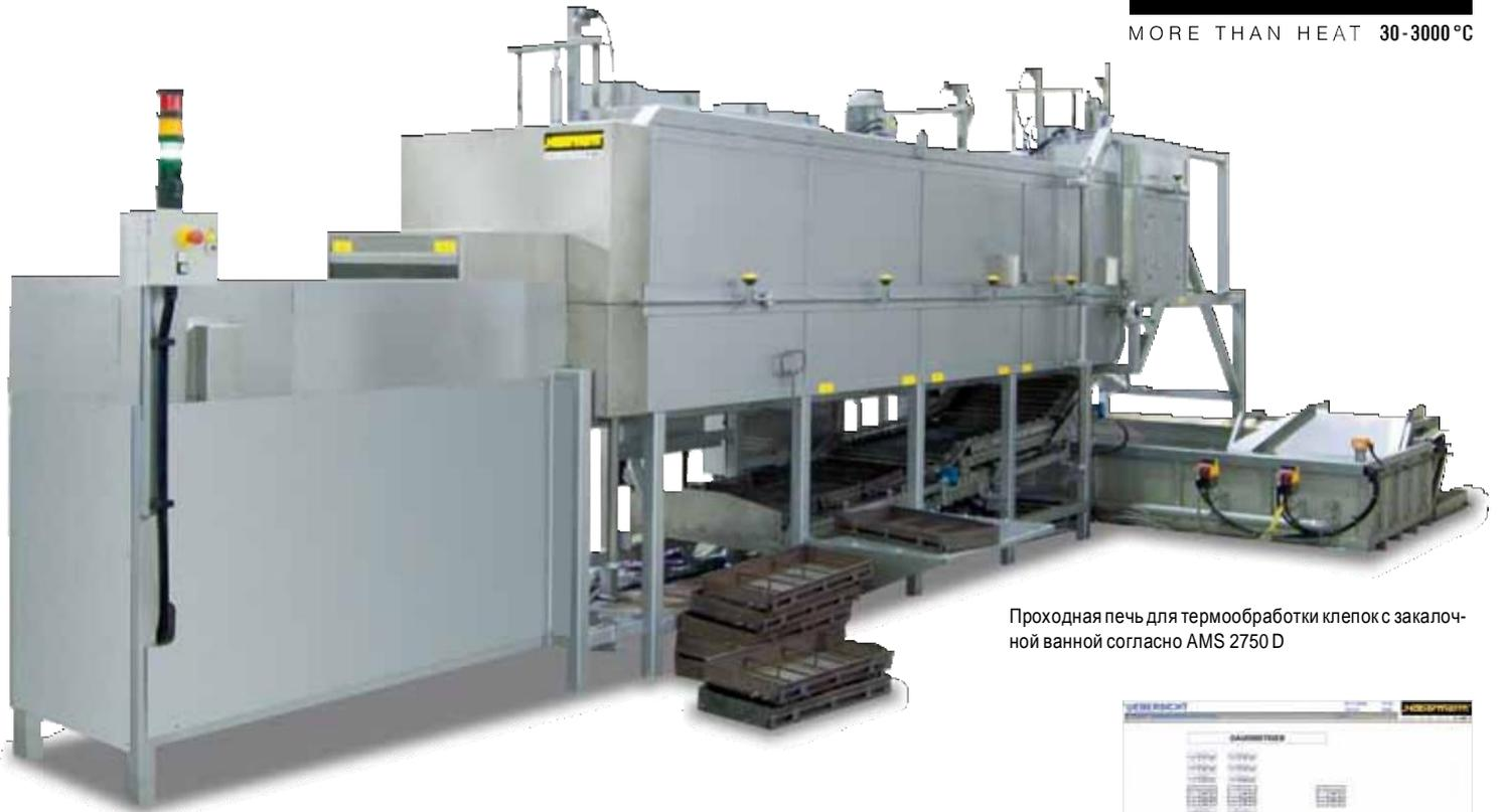
Проходная печь для термообработки клепков с закалочной ванной согласно AMS 2750 D
