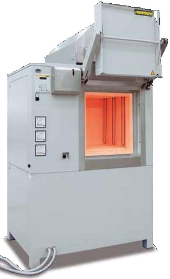
HT 128/17 S с подъемной дверцей для открытия горячей печи
