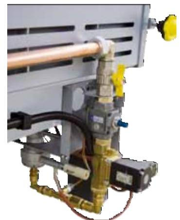
Газовая горелка на печи модели NB 660/WAX
