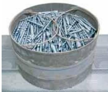
Воронение сверел водяным паром в печи серии NRA
