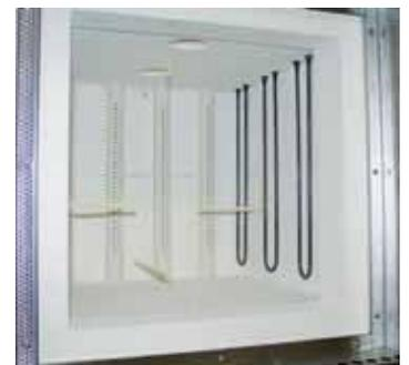
Впуск свежего воздуха через перфорированные нагревательные трубки, входящие в комплектацию для выжигания II
