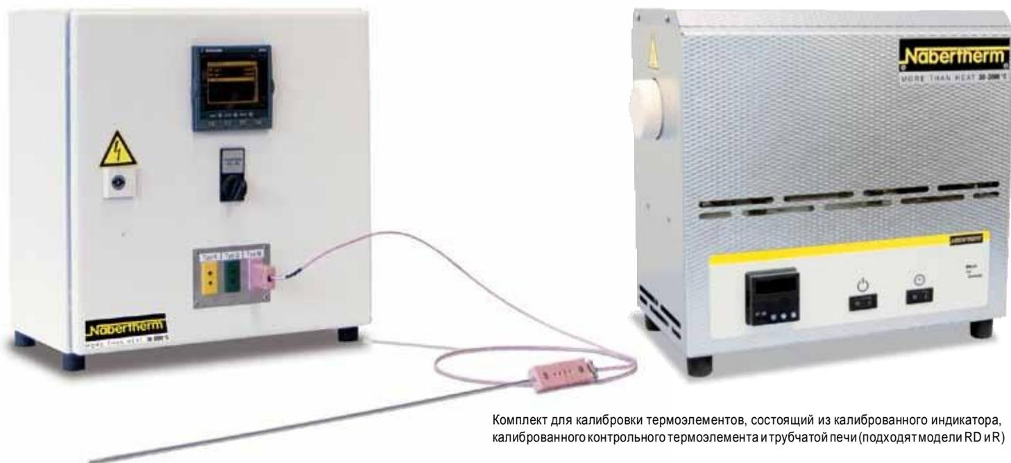
Комплект для калибровки термоэлементов, состоящий из калиброванного индикатора, калиброванного контрольного термоэлемента и трубчатой печи (подходят модели RD и R)
