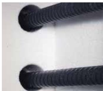
Пространство печи с высококачественным волокнистым материалом и нагревательными стержнями из карбида кремния с обеих сторон
