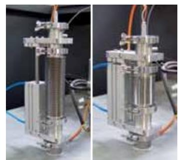
Термоэлемент типа Sc автоматическим устройством выдвигания для точного управления в нижнем диапазоне температур
