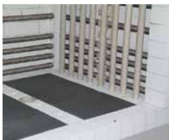
Вдувание предварительно нагретого воздуха через перфорированные трубки
