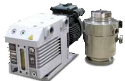
Насосный стенд с турбомолекулярным насосом и форвакуумным насосом для тепловой обработки в вакууме до 10<sup>-5</sup> мбар
