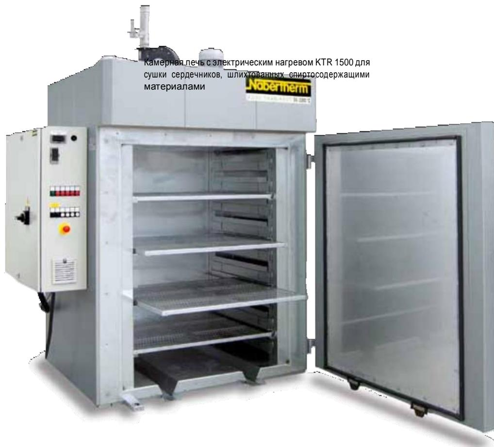
Камерная печь с электрическим нагревом KTR 1500 для сушки сердечников, шлифованных спиртосодержащими материалами
