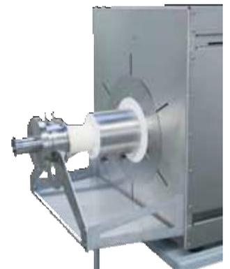
Газонепроницаемое исполнение с фланцами с водяным охлаждением
