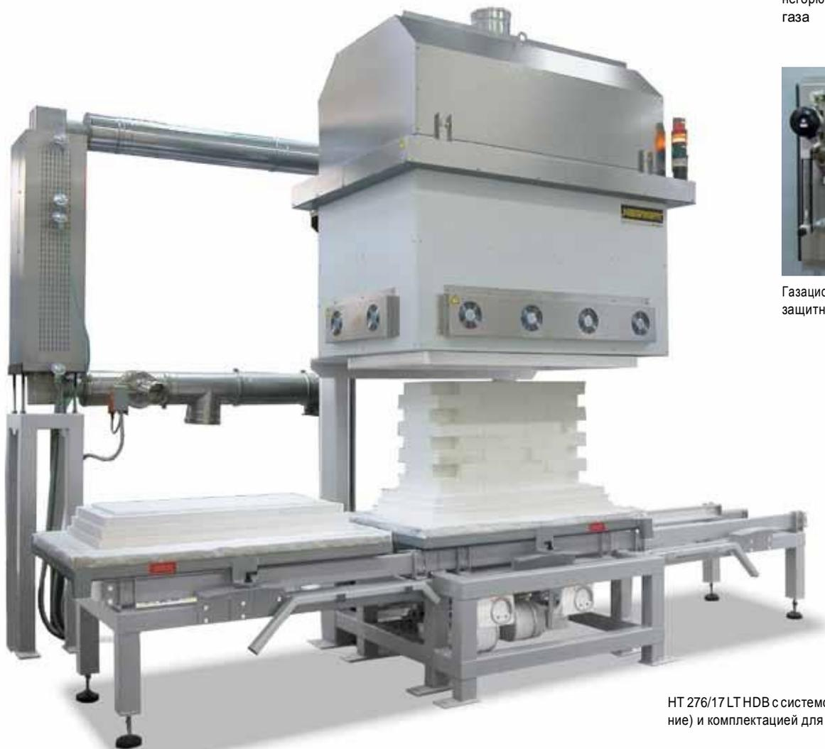
HT 276/17 LT HDB с системой смены столов (ручное управление) и комплектацией для выжигания II
