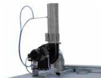
Отверстие приточного воздуха и мощная воздуходувка отводимого воздуха смонтированы на печи
