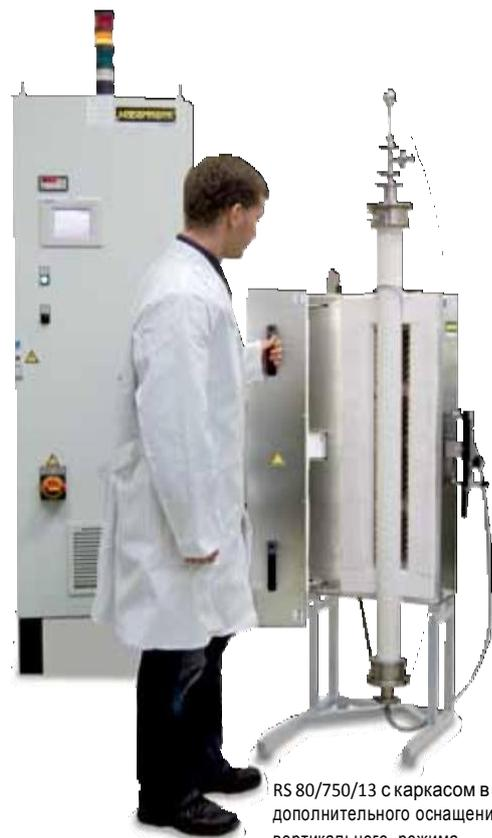
RS 80/750/13 с каркасом в качестве дополнительного оснащения для вертикального режима
