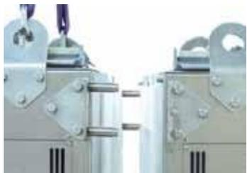
Цапфы для соединения двух отдельных полупечей
