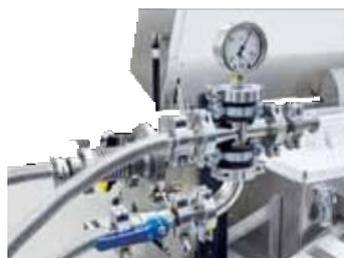
Комплект соединительных элементов для вакуумного режима
