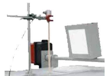
Заслонка отводимого воздуха и термоэлемент загрузки со штативом в качестве дополнительного оборудования
